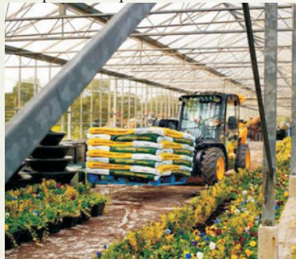
Модель JCB Miniscopic идеально подходит для применения в ограниченной рабочей зоне. Ее компактные размеры дают возможность легкого доступа к месту работы, а малая окружность поворота с управлением на 4 колеса обеспечивает прекрасную маневренность для эффективной работы в условиях замкнутых пространств. Для погрузчика доступны такие участки, в которых обычная техника при-
